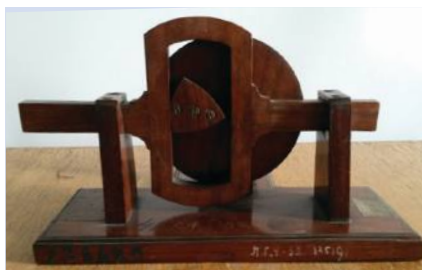
Треугольник Рёло в кулачковом механизме
